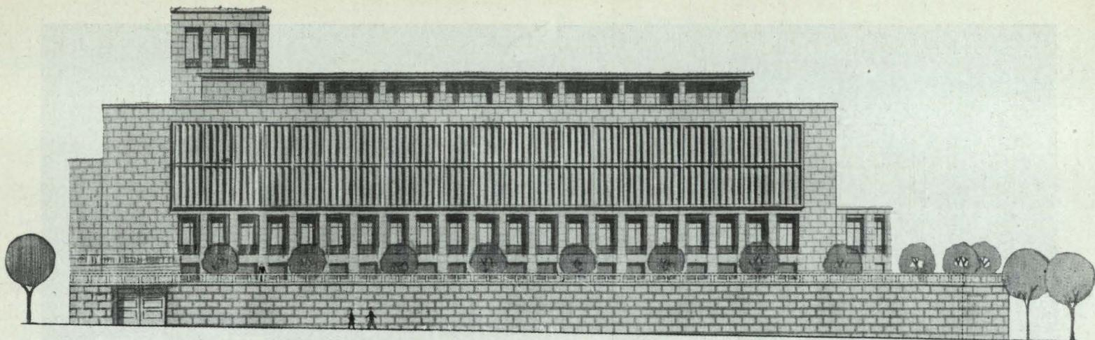
*Fachada orientación poniente sobre la Castellana. Protección de los huecos con «brise-soleil» móviles de eje vertical y con galería cubierta con toldos horizontales.*
