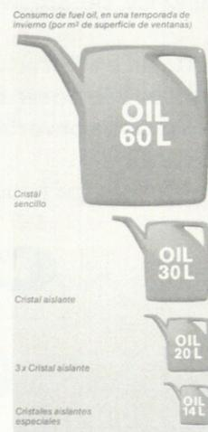
Por las ventanas normales se escapa, estadísticamente, un 37% del gasto de combustible, lo que supone la mayor pérdida de calor que se produce en una vivienda unifamiliar. Con Kömmerling y según el tipo de ventana elegido, puede ahorrarse hasta  $\frac{3}{4}$  partes de la energía térmica que se escapa por una ventana normal.
